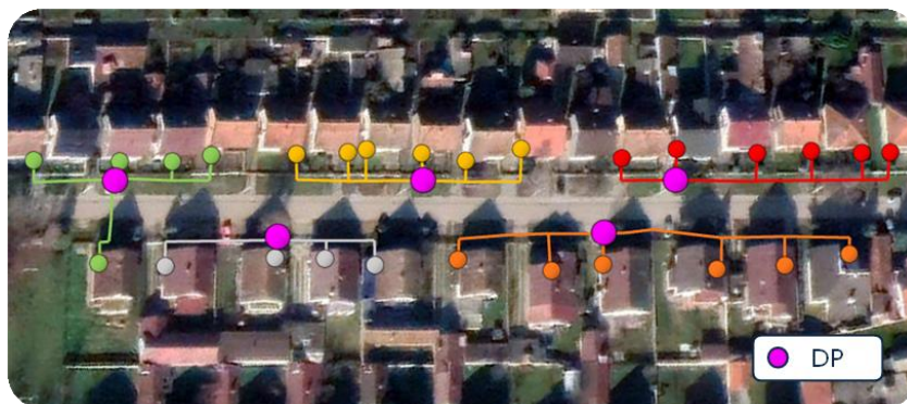
Slika 22 - Primjer veza između zgrada i izvoda (DP) kod bakrene mreže (Izvor: Axon)
